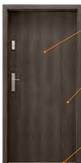
WYPEŁNIENIE PŁYTA WIÓROWO - OTWOROWA. RAMA ZE SKLEJKI I KLEJONKI DREWNA IGLASTEGO Klasa izolacyjności akustycznej Rw=27dB
